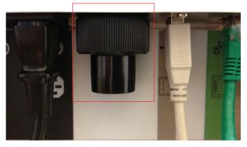
Fig. 3. Aerosol evacuation port.
